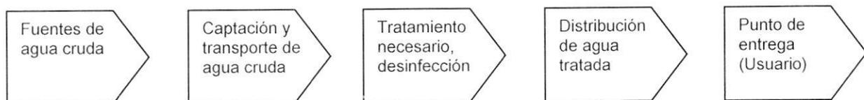
El agua ya potabilizada es transportada a presión mediante una tubería de conducción, usualmente a partir de un tanque de almacenamiento, de agua tratada instalada al final de los procesos de la planta de Potabilización, hasta empatar con la red de tuberías de distribución a la población atendida por el
